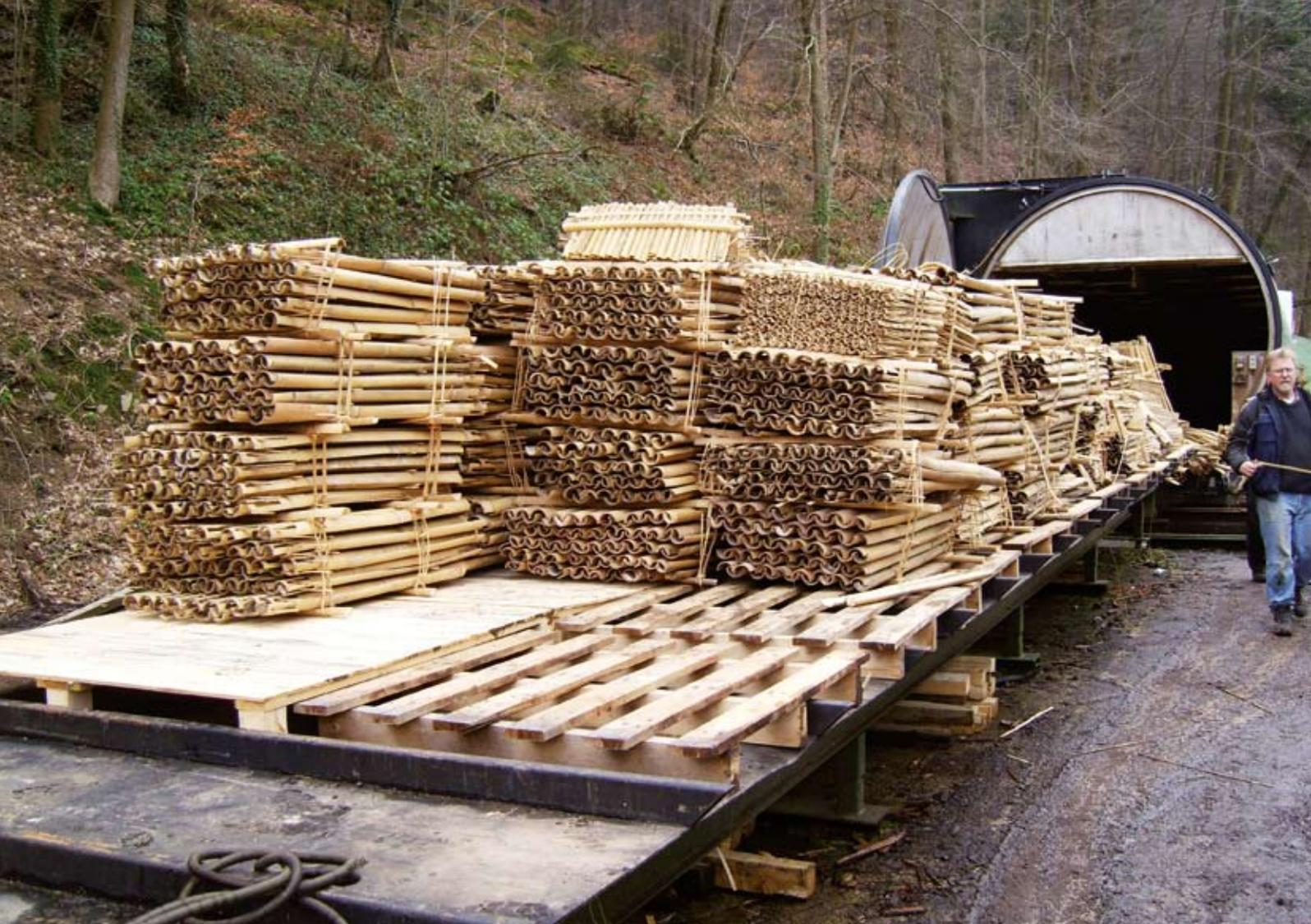
Abb. 4: Beladung der Trockenkammer mit Bambus.
